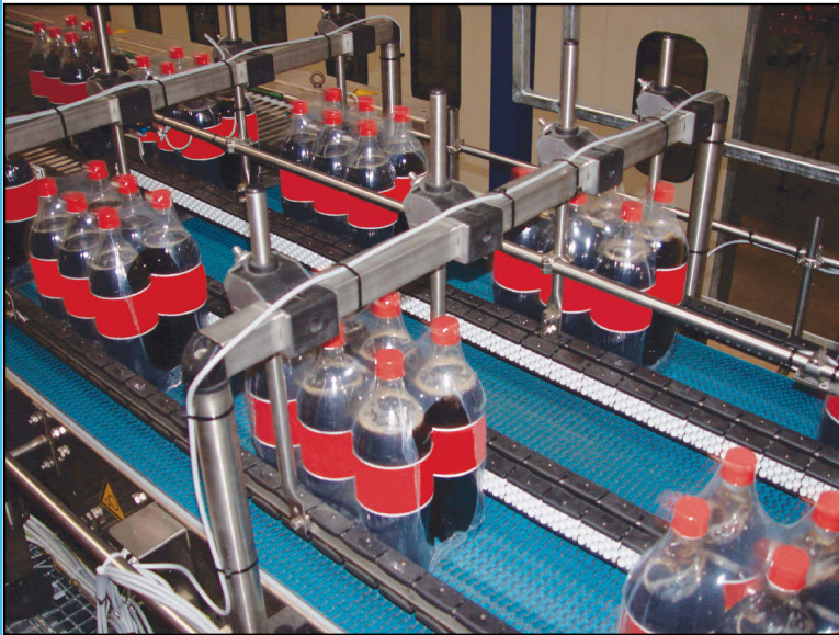
Förderanlage für positionierte Produkte für Palettierer
