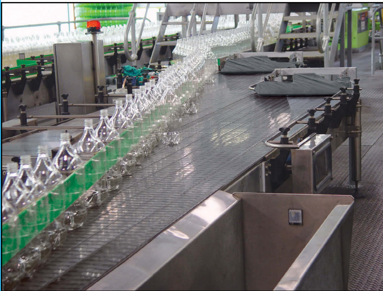
Vom Massentransport zu einspurigem Transport mithilfe von Modulband 2251
