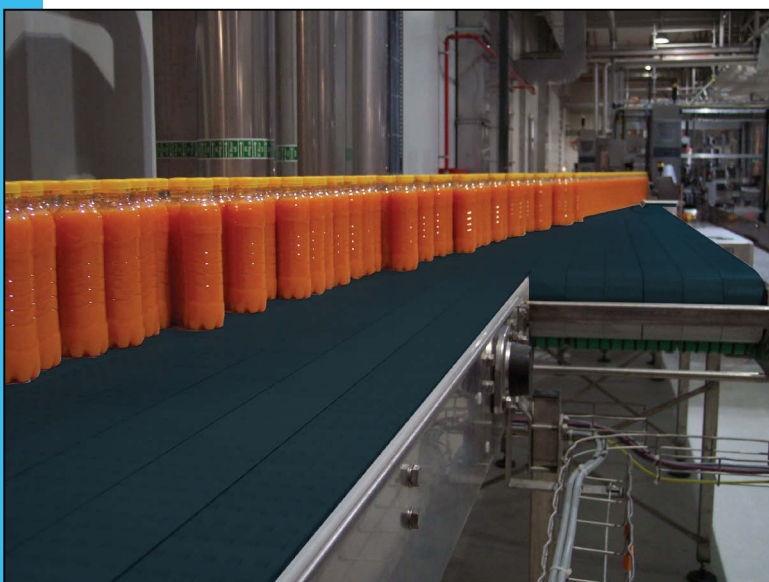
Vom Massentransport zu einspurigem Transport mithilfe des 2250-Modulbands.
