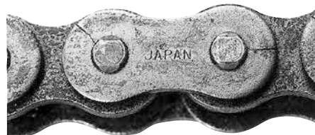
Risse durch Wasserstoffversprödung
