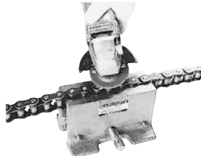
Abschleifen der Bolzenenden
