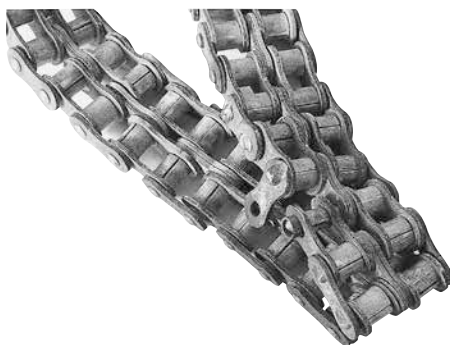
Korrosion einer Rollenkette aus Edelstahl
