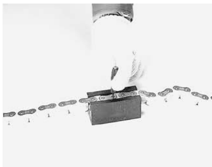
Trennen der Poly-Stahl-Kette
