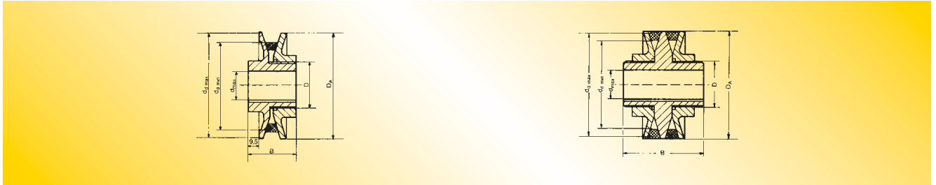
Regelscheiben für zylindrische Bohrung Variable speed pulleys for plain boring Material: GG
