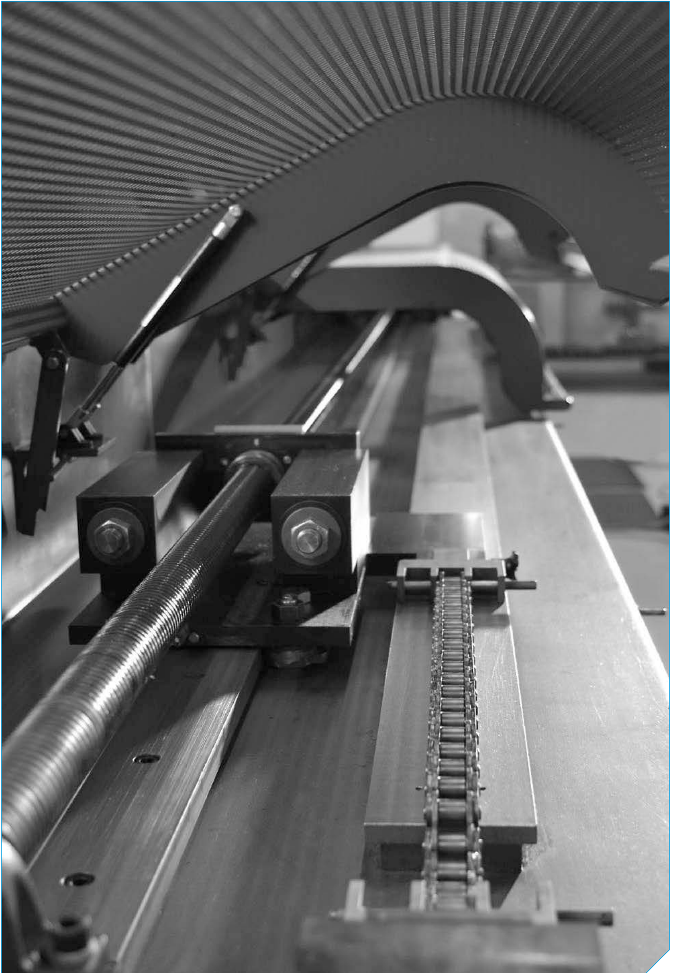
Matchy – Vorrichtung zum paarweisen Vorrecken für Parallellauf
